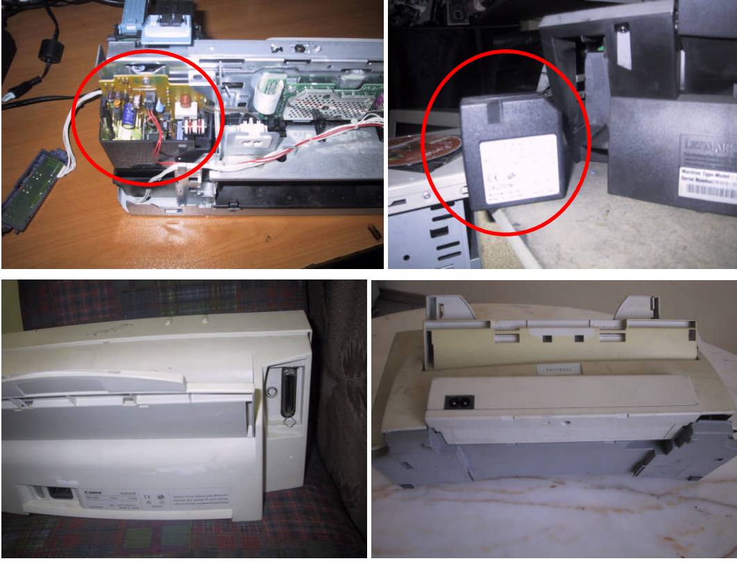
Resim 2.2: Kendinden beslemeli yazıcı türlerinde adaptör seçme (220 V şebeke gerilimi yazıcıya direkt uygulanır.)
