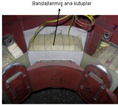
Resim 2.1: Bandajlanmış ana ve yardımcı kutuplar
