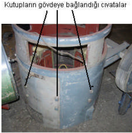
Resim 1.6: DA kaynak makinesinin gövdesi ve kutup bağlantı civataları
