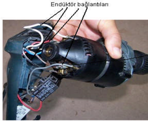
Resim 1.5: Üniversal motor kutup bağlantıları
