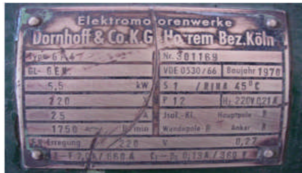
Resim 1.7: DA motora ait etiket
