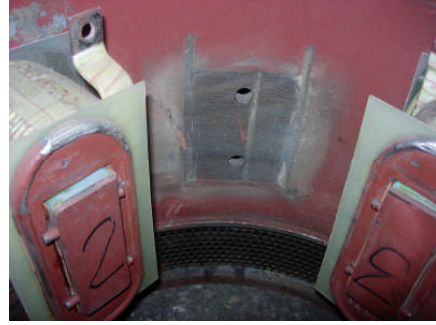
Resim 2.2: Kutup sargılarının endüviye bağlanması Resim 2.3: Kutup ayaklarının söküldüğü yer
