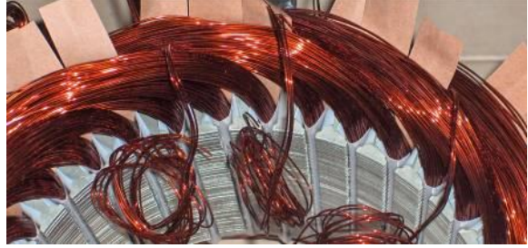
Resim 3.9: Yerleştirilmiş bobinlerin görünümü
