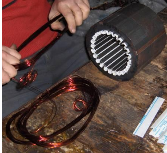
Resim 3.1: Stator iletkenlerinin düzeltilmesi
