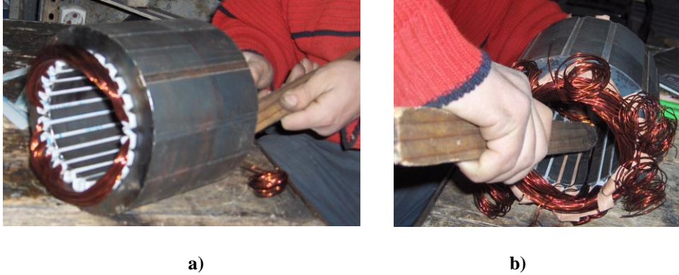
Resim 3.6: (a,b) Oluk sürgü çubuğu ile bobinlerin yerleştirilmesi
