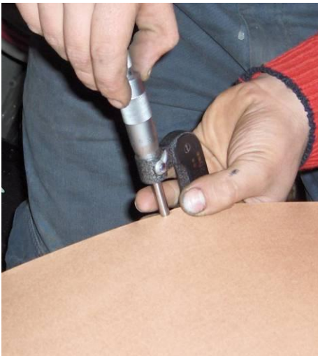
Resim 2.3: Presbant ölçüsünün alınması
