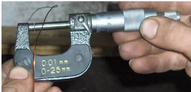
Resim 1.12: Mikrometre ile bobin çapının bulunması
