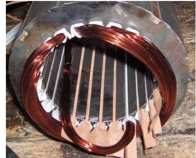
Resim 3.7: Yalıtılmış faz bobinleri üzerine bobin yerleştirilmesi
