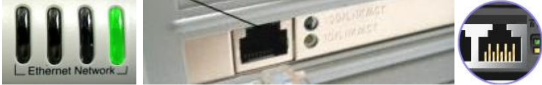
Resim 2.3: Hub ve ethernet kartı ışıkları
