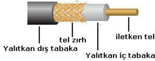
Şekil 2.11: Koaksiyel kablo iç yapısı
