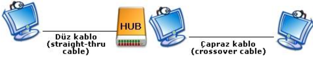
Şekil 2.8: Düz ve çapraz kablo bağlantısı
