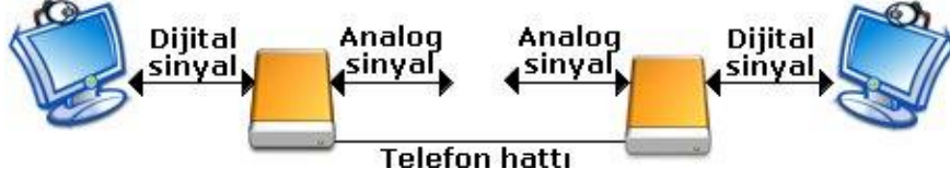
Şekil 2.9: Modem çalışma prensibi
