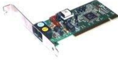
Resim 2.9: Dahili (internal) modem
