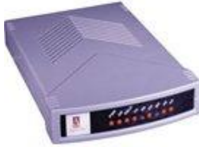
Resim 2.10: Harici (external) modem
