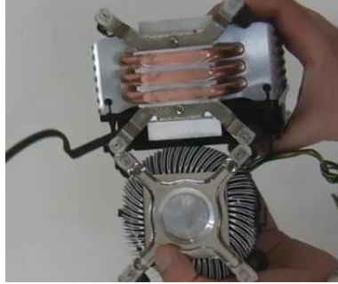
Resim 2.12: Isıl borulu ve havayla soğutma sistemleri
