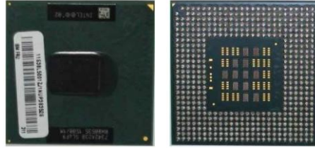
Resim 1.5: 478 pin FC-PGA paketi ön ve arka yüzü
